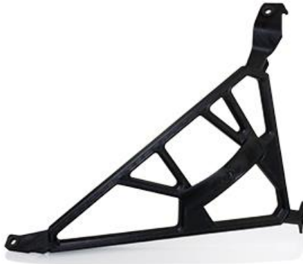
Figura 3.9. Soporte impreso con Nylon 6
