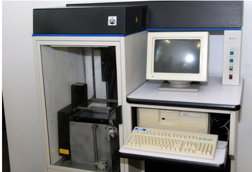
Figura 1.3. Máquina SLA-1 inventada por Charles “Chuck” Hull en 1987 y actualmente exhibida en “National Inventors Hall of Fame” de Virginia, EU.
